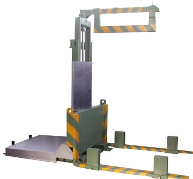
Il veicolo viene posizionato sulle forche di appoggio tramite distanziatori regolabili. Viene dapprima bloccata dal braccio pressore nella zona della cappotta e successivamente fatta ruotare di 90°.
