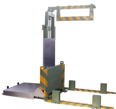
Con il veicolo posizionato sul fianco, l'operatore può effettuare tutte le operazioni di smontaggio dei componenti sottoscocca in modo comodo, sicuro e di facile accesso.
